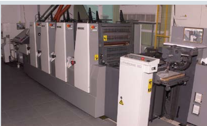
Четырехкрасочная Komori Lithrone 20 используется для работ в несколько проходов или при пиковых нагрузках
