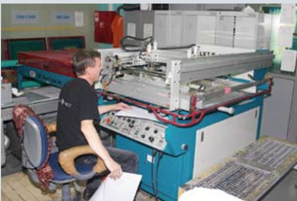
Для нанесения кроющих и декоративных красок в производстве карточек используется трафаретная печать
